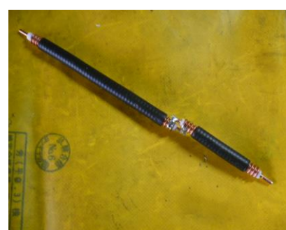
試しに半田付けして接続しました 芯線とシールド部の接続です
