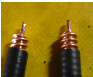
左、アンドリュー社製 右、三菱 螺旋です 瓢箪型の山と谷です
